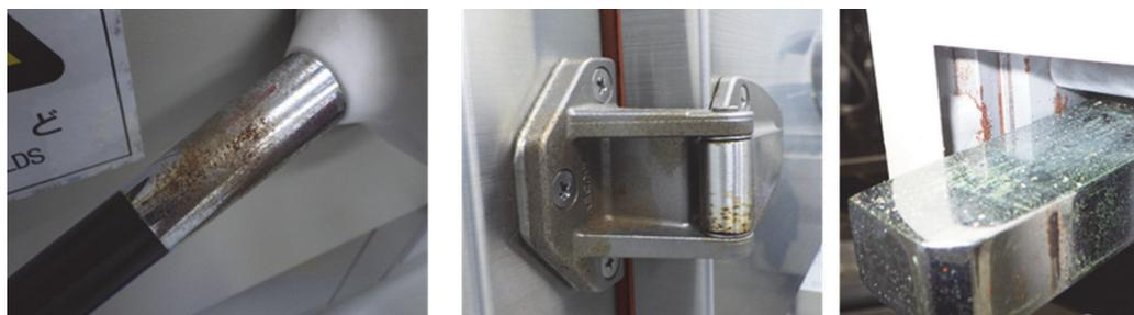
図 15. 実験室内に発生した錆
