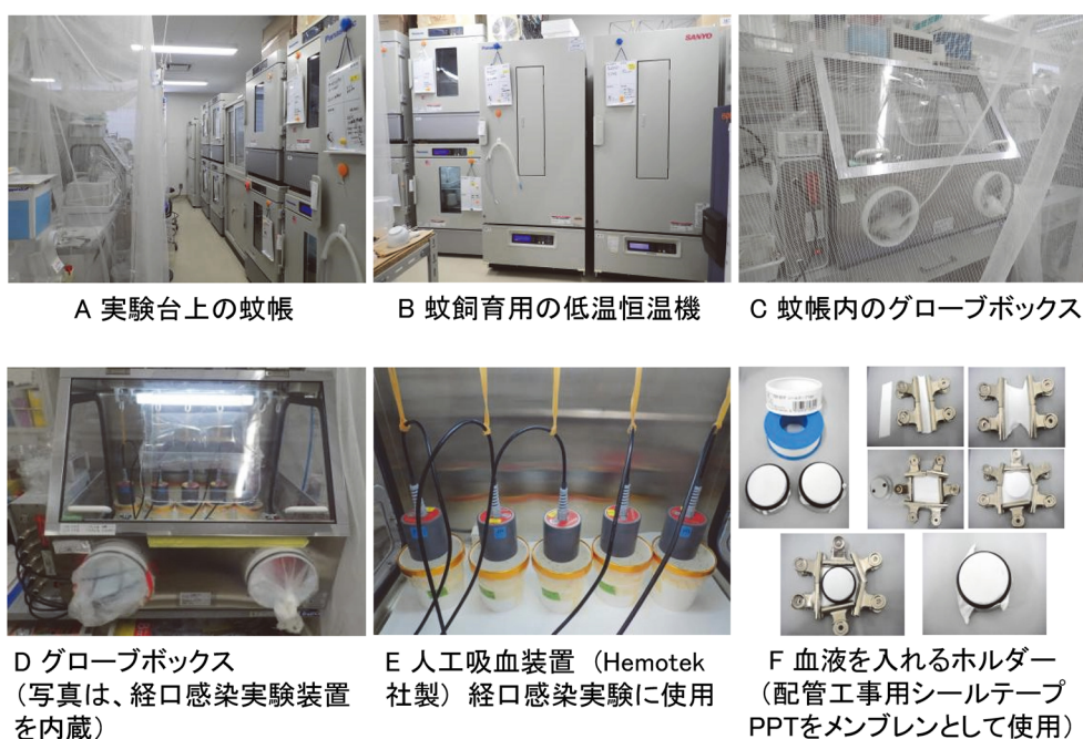
写真 2. 媒介節足動物飼育室の逃走防止設備と実験装置
