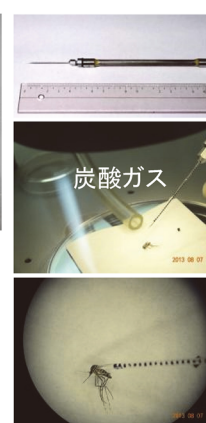
D 1mm間隔の目盛付接種用硬質ガラス針、1目盛=0.2μL相当（ナリシゲ装置またはアルコールランプで作製）
