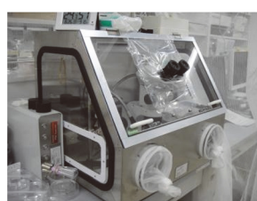
C 北海道大学：BSL2（経口感染実験用）、BSL3（経口感染・病原体接種実験用）施設に設置したグローブボックス（写真は、成虫用接種装置を内蔵。経口感染実験装置内蔵は写真2D、2Eを参照）
