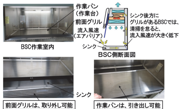
図 8. 前面グリル下のシンクの清掃
