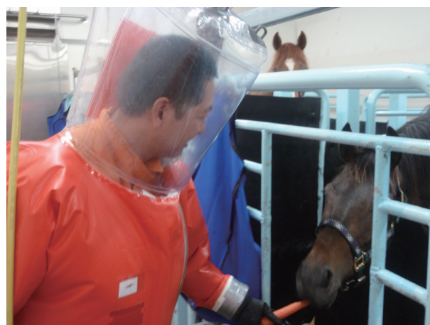
図4. 陽圧防護宇宙服。LAF内BSL4大動物実験室。 BSL4内での作業では、スタッフは陽圧防護宇宙服（スーツと呼ばれている）を着用して、高病原性病原体から守られている。空気は写真左端の黄色いホースを介して外部からスーツ内へ供給される。
