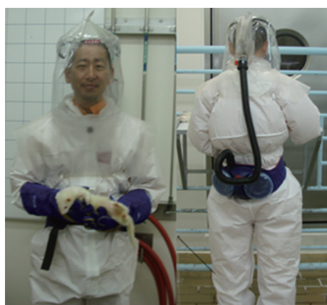
図3. 電動空気清浄器付防毒マスク。 空気は腰の電動吸気ヘパフィルターを介してフード内に供給される。動物は麻酔下で取り扱い、ゲージからの取り出しの際には咬まれても大丈夫なグローブを着用。
