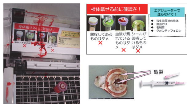
図2. 採血管破損例
