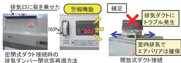
図8. 排気ダクト接続時のトラブルを再現
