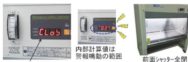
前面シャッター全閉時は、風速表示と風速低下警報を解除
