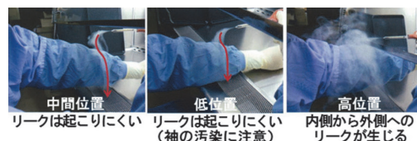
図 2. 腕を挿入する高さで漏洩の可能性
